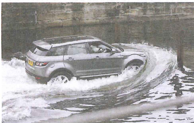
Die Bodenfreiheit und das überzeugende Fahrzeugkonzept ermöglichen Flussdurchfahrten bis zu einem halben Meter Wasserhöhe.
